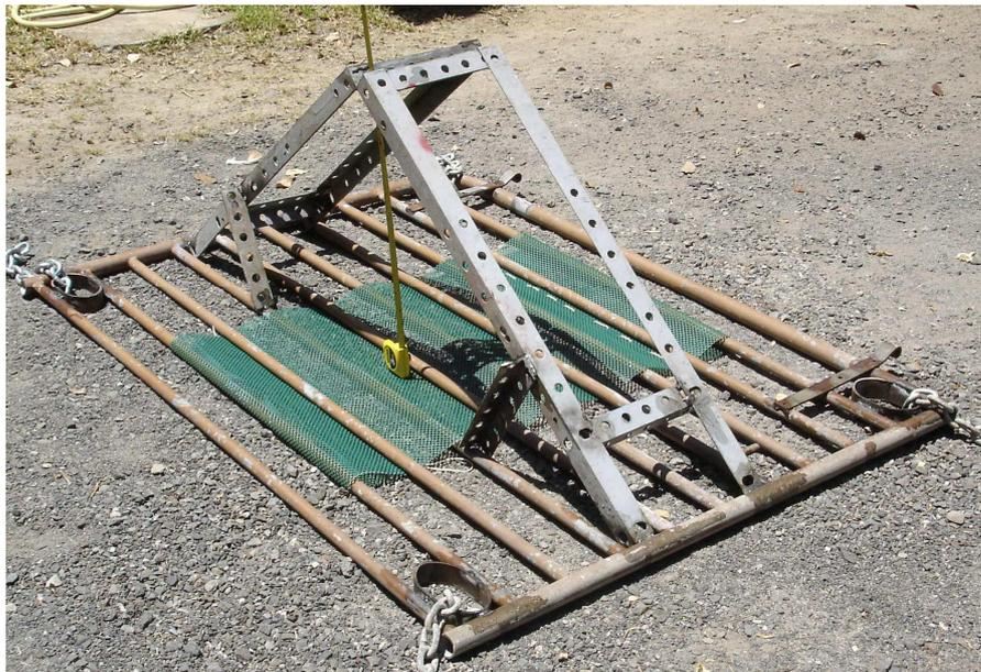
Fig. 11 : Schéma de construction du système d'amarrage des stations d'écoute fixées sur le fond (d'après R. Troadec).
